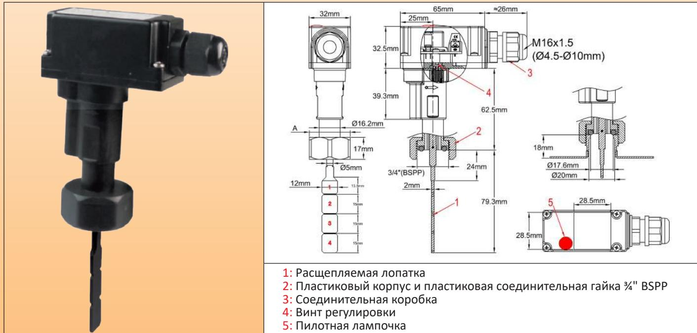
**Основное применение:** общее применение в обнаружении потока. Рекомендуемое положение монтажа - на горизонтальных трубах, но может быть установлен в любом положении. Для обнаружения потока воды на водопроводных трубах диаметром от 15 до 100 мм. **Встроенное реле с контактом SPDT может использоваться на резистивных нагрузках до 15A 250V. Пилотная лампочка показывает положение контакта.**
